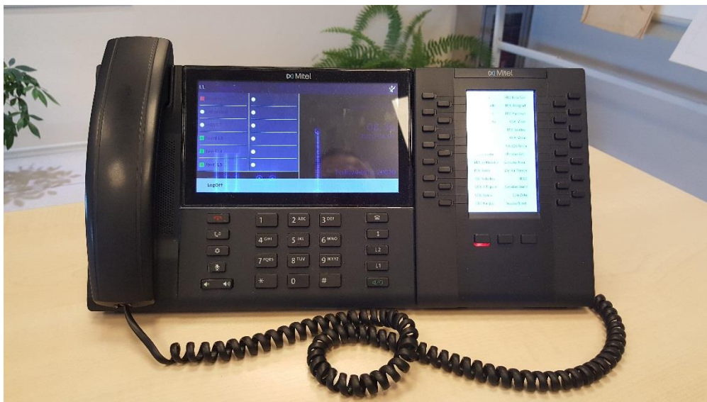
SLIKA 2. REALIZACIJA DISPEČERSKE KONZOLE SA MITEL 6873I I M685I
